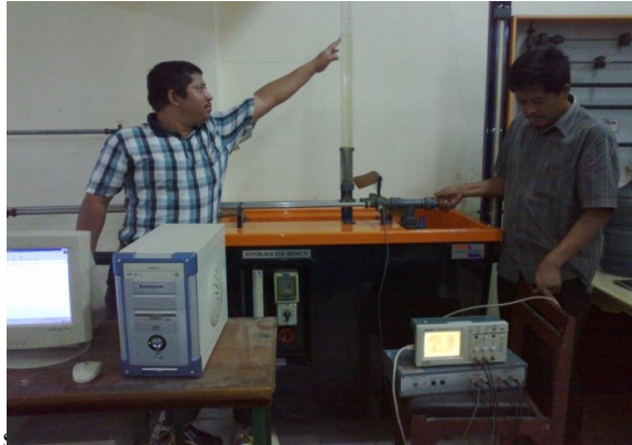
Gambar 3. Pembacaan perubahan muka air sebagai fungsi waktu di surge shaft untuk berbagai variasi kecepatan aliran
