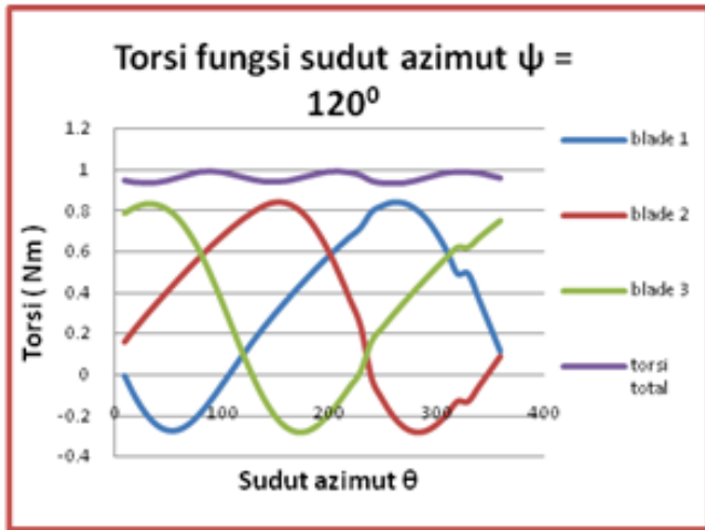
Gambar 10. Torsi fungsi sudut azimuth untuk \psi = 120^\circ .
