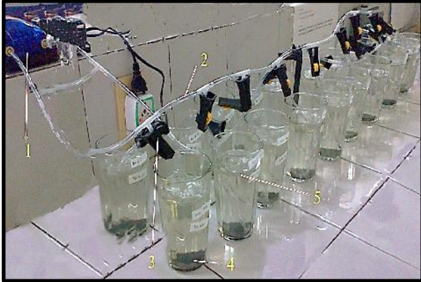
Gambar 1. Rangkaian Alat Uji Korosi
