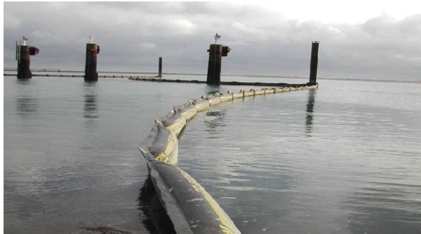
Gambar 3. Penggunaan oilboom dalam pengendalian pencemaran minyak (Violeau et al 2007)
